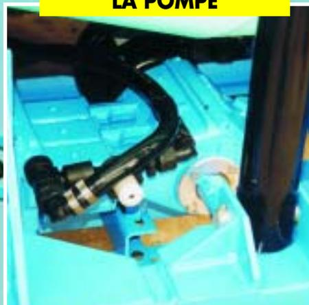
**100% BERTHOUD** : les pompes GAMA à 3 pistons, sans cloche à air, garantissent : volumétrie, précision et fiabilité pour une large plage de variation du régime de la prise de force. Les pompes GAMA garantissent la précision des régulations DPM et DPE.
