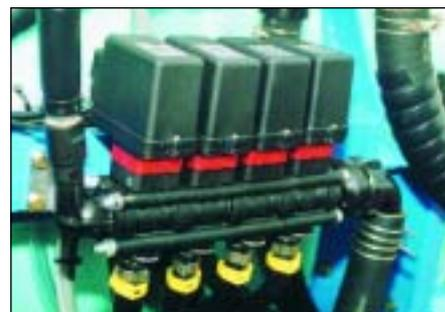
La commande de la pulvérisation est assurée depuis la cabine du tracteur par des vannes électriques à clapet (VEC)
