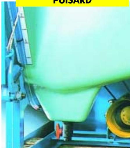
**100% BERTHOUD** : Un fond de cuve en pointe de diamant associé à un puisard minimal permettant de traiter même en dévers sans risque de désamorçage. Une vanne 1/4 de tour permet la récupération en toute sécurité de la bouillie non utilisée.
