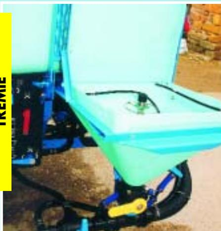
**100% BERTHOUD** : la trémie escamotable permet l'introduction de la majorité des produits phytosanitaires. Elle dispose d'un circuit de rinçage et d'un rinçage-bidons alimentés à partir de la cuve de rinçage du pulvérisateur.
