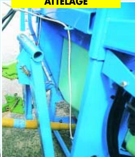
**100% BERTHOUD** : d'origine un attelage automatique intégré au châssis pour un déport arrière minimal et une plus grande sécurité lors de l'attelage au tracteur.
