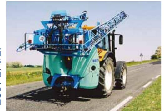
El ancho de Elyte, sea cual sea el modelo de barra, es inferior a 2,55 m. Se ajusta, pues, al gálibo de carretera. Puede circular con total seguridad a 40 km/h... ¡y con total serenidad!
