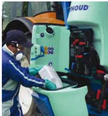
La tolva de incorporación puede alimentarse por el circuito de aspiración exterior, permitiendo así incorporar los productos, enjuagar la tolva y los bidones con agua limpia. Es un dispositivo que anula el enjuague del circuito de incorporación y permite reducir los volúmenes de líquidos fitosanitarios.
