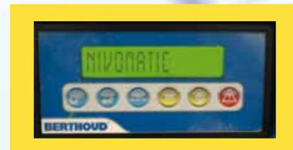
El medidor de nivel Nivomatic permite además programar un volumen de llenado. Una vez alcanzado el volumen, puede disparar una alarma acústica o una señal para detener el llenado. Una solución eficaz para evitar derrames accidentales.
