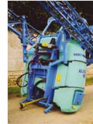
El enganche automático integrado en el chasis permite realizar esta operación con toda sencillez y con la máxima seguridad. El enlace tractorpulverizador lo facilita la longitud del cardán de arrastre de la bomba situada en la parte posterior del aparato.
