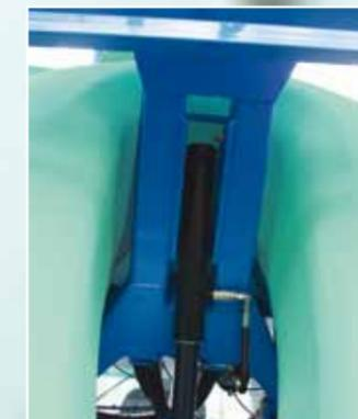
La cuba principal de Elyte tiene un sumidero con evacuación por descarga lateral, que permite un vaciado total antes del descebado de la bomba. Canalizados en el interior del brazo central, las mangueras son más cortas, lo cual reduce el volumen residual.
