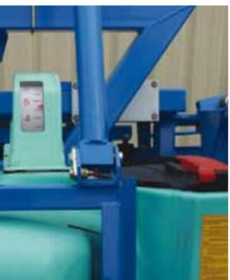
Se ofrecen cuatro modelos de medidor de nivel. De origen, Elyte está equipado con un medidor de lectura directa. Opcionalmente, puede dotarse de un medidor de tambor o de los medidores electrónicos Nivelec y Nivomatic. Situado en la parte delantera del aparato, el nuevo medidor de nivel de tambor Berthoud es a la vez preciso y fácil de leer, tanto desde la cabina como desde el puesto de llenado.
