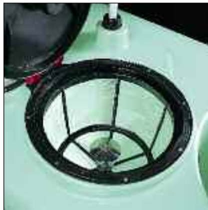
Tamiz de relleno con incorporador de polvos
