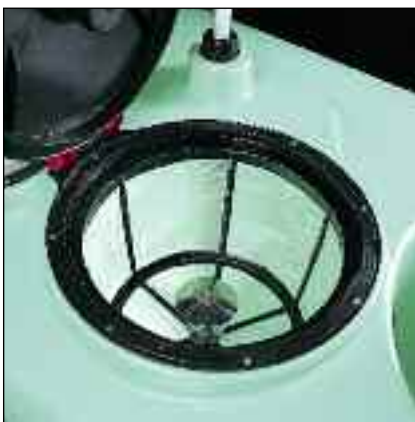
Relleno con incorporador de polvos
