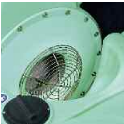
Orificio de aspiración del ventilator
