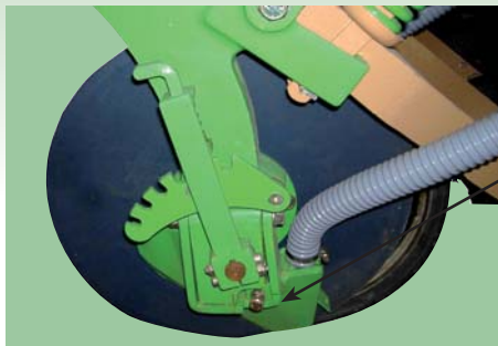
Caída de la semilla en la parte trasera del disco
